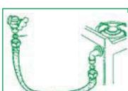
1 - Připojení hadice ke kulovému kohoutu lze provést závitovým spojem s těsnící páskou určenou pro plyn nebo pomocí plochého těsnění určeného pro plynové spoje v závislosti na typu připojení hadice a kulového kohoutu.
