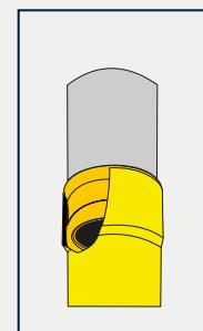
5. Tlakem na trubku vznikne požadovaná rolující účinnost úkonu. Vtlačením a ponořením Rollfixu až pod nákrúžek jste docílili ideálního spoje.
