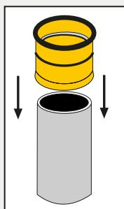
1. Rollfix nasuňte nákrúžkem vzhľru až po doraz obruby na vnitřní stěnu.
