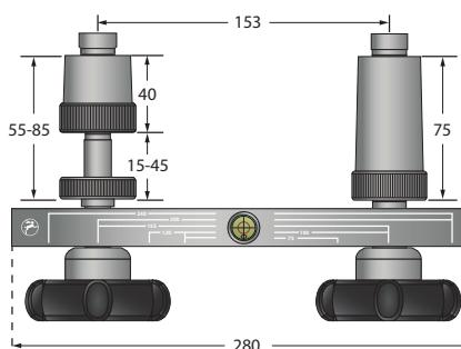
**OTTO HAAS Montagehilfe** aus massivem Aluminium inklusive zweier Aufnahmen aus Aluminium mit G  $\frac{1}{2}$ ". Die Aufnahme ist variabel über das Gewinde einstellbar. 7 Bohrungen, mit Hilfsskala für die sechs gängigen Montagemaße z.B. 153 mm (für Urinalanschlüsse), 120 mm (für Waschtischanschlüsse).
